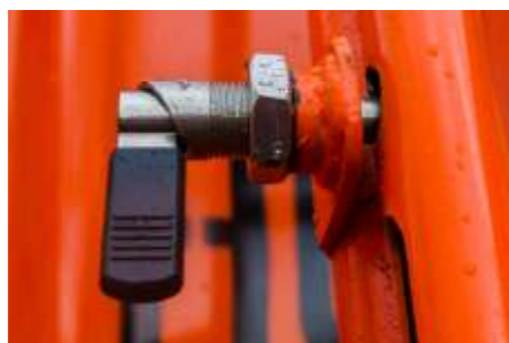
Фиксатор лестницы от самопроизвольного раскладывания
