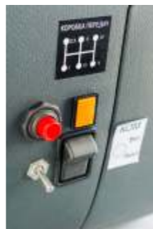
Кнопки включения КОМа из кабины, массы и проблескового маячка.
